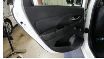
Döşemeler/Kapaklar, Kapı döşemesi, sol arka > Deforme Olmuş
