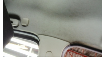
Döşemeler/Kapaklar, Tavan döşemesi > Deforme Olmuş
