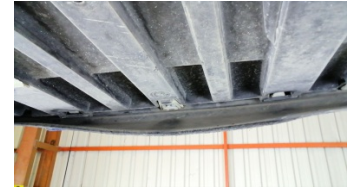
Tampon, ön, Spoiler > Deforme Olmuş
