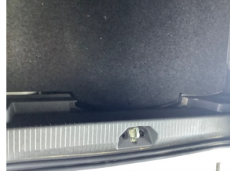
Döşemeler/Kapaklar, Yükleme eşiği kaplaması > Çizik
