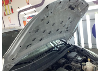
Motor kaputu, İzolasyon döşemesi > Sökülmüş-Yok
