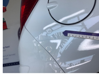
Çamurluk, sağ arka, Çamurluk, sağ arka > Ezik
