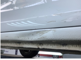
Marşbiyel, sağ, Marşbiyel, sağ > Hasarlı
