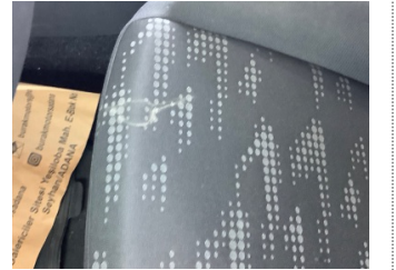
Koltuklar, ön, Koltuk, sol ön > Deforme Olmuş
