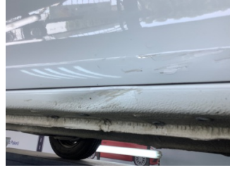
Marşbiyel, sağ, Marşbiyel, sağ > Hasarlı
