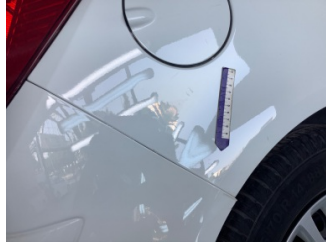
Tampon, arka, Bağlantı ayağı > Hasarlı
