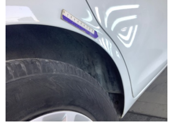
Çamurluk, sağ arka, Çamurluk, sağ arka > Ezik
