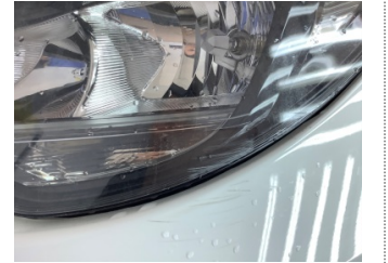
Farlar, Far, sol > Hasarlı
