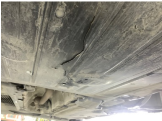
Motor, Alt muhafaza > Hasarlı
