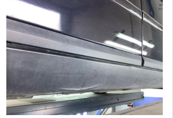
Marşbiyel, sağ, Marşbiyel plastiği, sağ > Hasarlı
