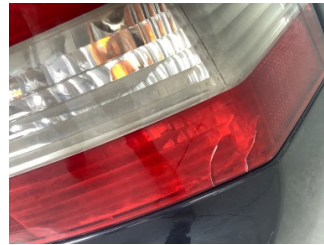
Arka lambalar, Arka lambalar, sağ > Hasarlı
