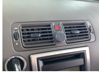
Kalorifer/Klima, Havalandırma ızgarası > Deforme Olmuş
