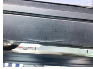
Marşbiyel, sağ, Marşbiyel plastiği, sağ > Hasarlı
