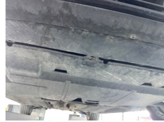
Motor, Alt muhafaza > Hasarlı
