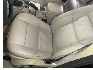
Koltuklar, ön, Koltuk, sol ön > Deforme Olmuş
