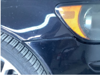
Tampon, ön, Bağlantı ayağı > Hasarlı
