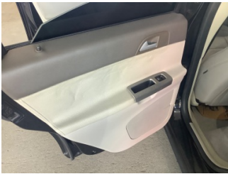
Döşemeler/Kapaklar, Kapı döşemesi, sol arka > Deforme Olmuş
