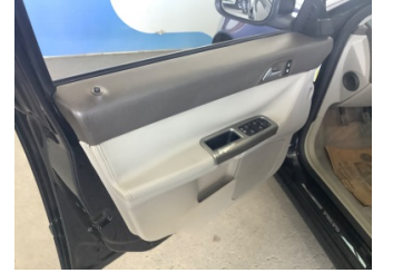
Döşemeler/Kapaklar, Kapı döşemesi, sol ön > Deforme Olmuş
