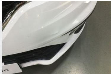
Ön tampon hasarlı
